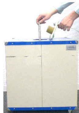
線源棒収納器に線源棒を格納して施錠の上、保管
